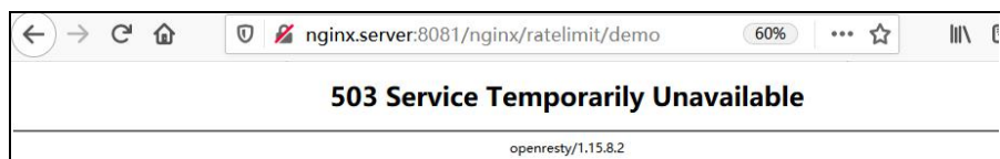
图 10-11 Nginx 限流后 10 秒内连续刷新第 1 次之后的输出
