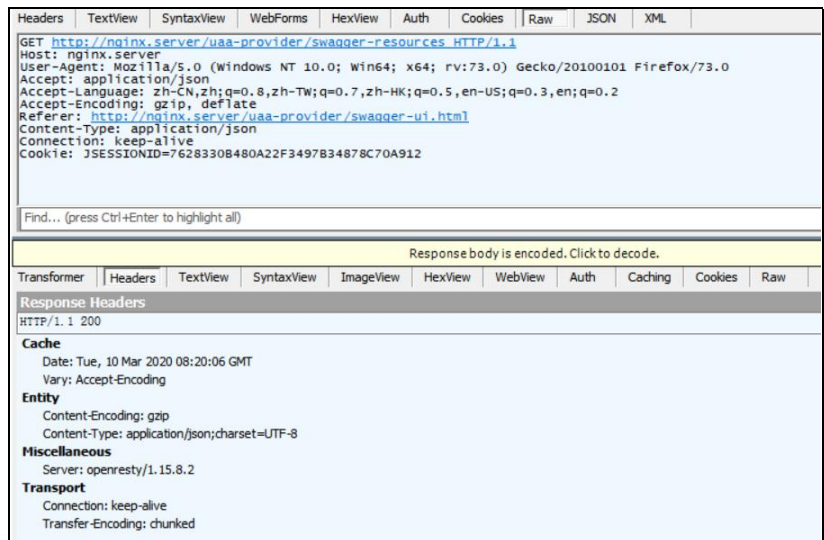
图 2-3 使用 Fiddler 查看 HTTP 报文的请求头和响应头
