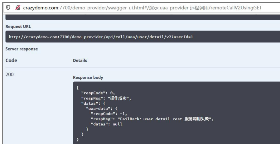
图 3-17 UserClientFallback 回退处理类生效后的示意图
